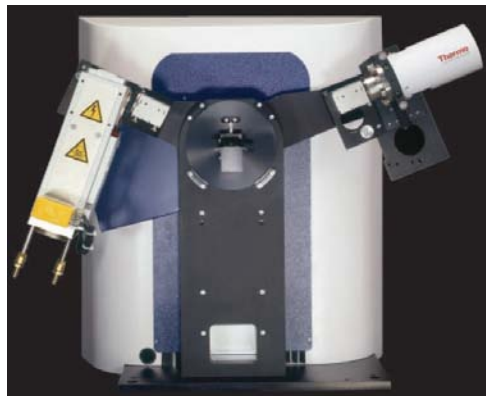
Obr. 9. Príklad súčasného difraktometra s \theta/\theta usporiadaním. Na ľavom ramene je zdroj rtg. žiarenia, v strede nosič pre vzorky a na pravom ramene detektor.
