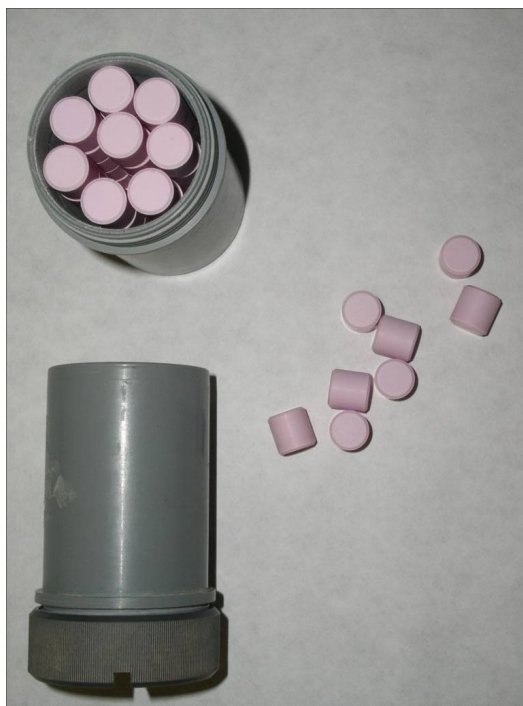
Obr. 9 Korundové valčeky a nádoba pre nich a vzorku.
