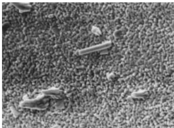
Obr.7: Cínová vrstva na rovinných plochách špatného konektoru. Zv.1000x.
