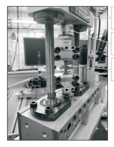
Tensile testing rig
