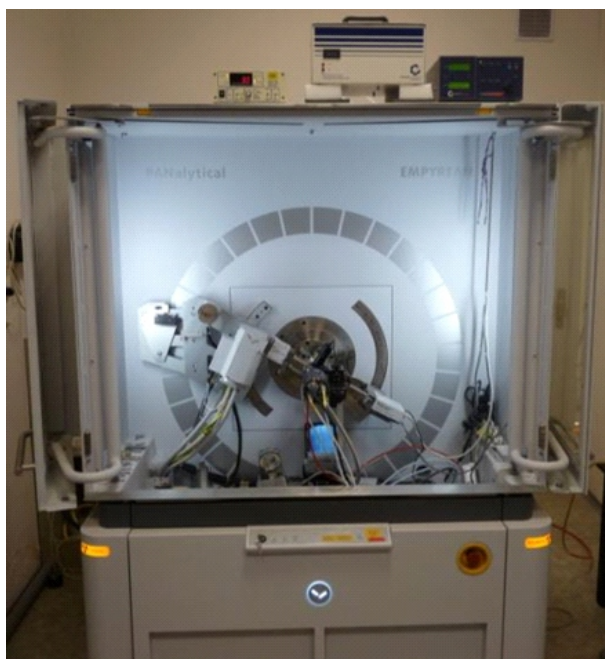
Obrázek 1: Difraktometr Emyrean vyfocený s nejpoužívanější konfigurací: Debye-Scherrer uspořádání - fokusační zrcadlo, vzorek v kapiláře, PIXCel 3D detektor a případné chlazení vzorku.
