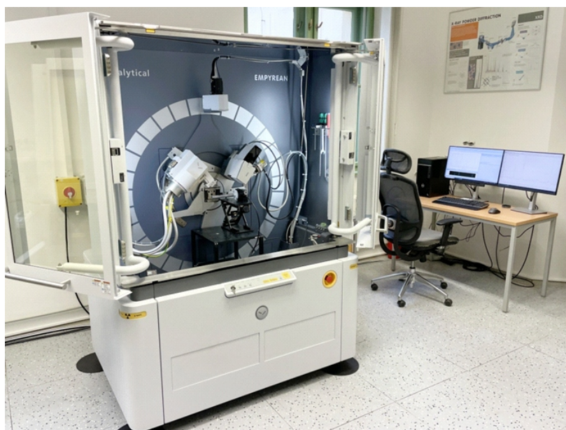
Obrázek 1. Difraktometr Empyrean (PANalytical) s účinným pozičně citlivým detektorem 1Der s vysokým energetickým rozlišením.
