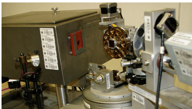
Obrázek 3: Difraktometr s Bartelsovým monochromátorem upravený na Mo rtg lampu pro měření difrakce a rtg fluorescence.
