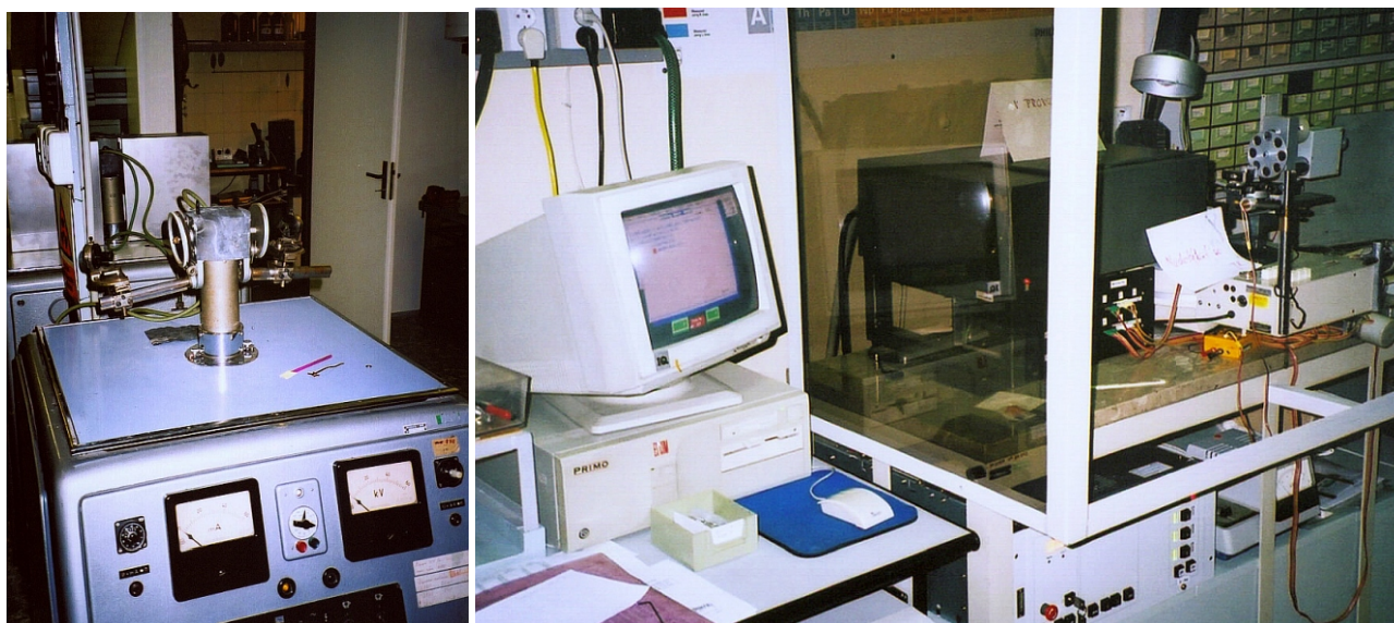
Obrázek 1: Rtg laboratoř s temnou komorou a původními zdroji Mikrometa 2E (vlevo) a difraktometr s Bartelsovým monochromátorem pro měření difúzního rozptylu s vysokým rozlišením na přelomu tisíciletí (vpravo).
