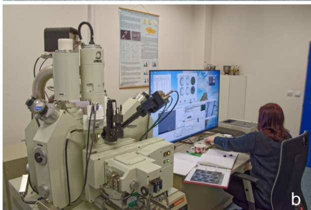
Obrázek 4. Elektronový mikroanalýzátor CAMECA SX-100 provozovaný v letech 2002 až 2019 (a) a jeho nástupce JEOL JXA-8230 Superprobe (b). Foto: R.Skála.
