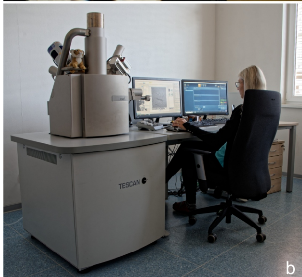
Obrázek 2. Elektronový mikroanalýzátor JEOL JXA 50A v „odstrojené podobě“ fungoval mezi lety 1994 a 2009 jako rastrovací elektronový mikroskop s ED spektrometrem EDAX (a). V roce 2010 byl nahrazen SEM TESCAN VEGA3 XMU (b). Foto: Z. Korbelová (a) a R. Skála (b).
