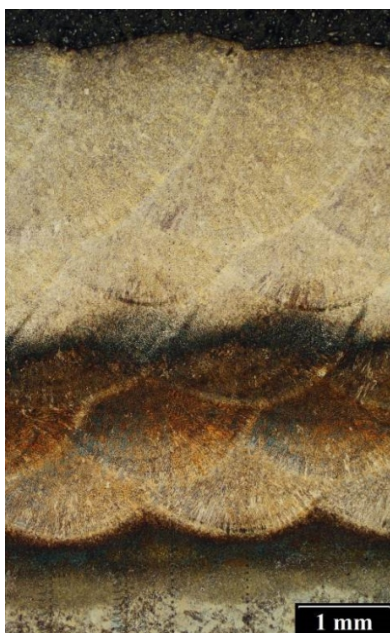
Obrázek 1. Výbrus návaru s výrazněnou mikrostrukturou.
