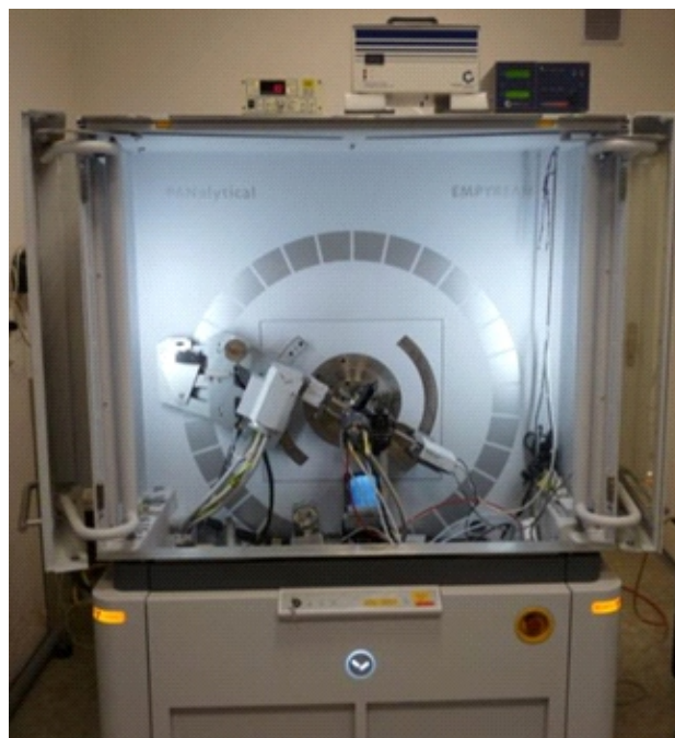
Obrázek 2: Nejpoužívanější konfigurace přístroje: Debye-Scherrer uspořádání - fokusační zrcadlo, vzorek v kapiláře, PIXCel 3D detektor a případné chlazení vzorku.
