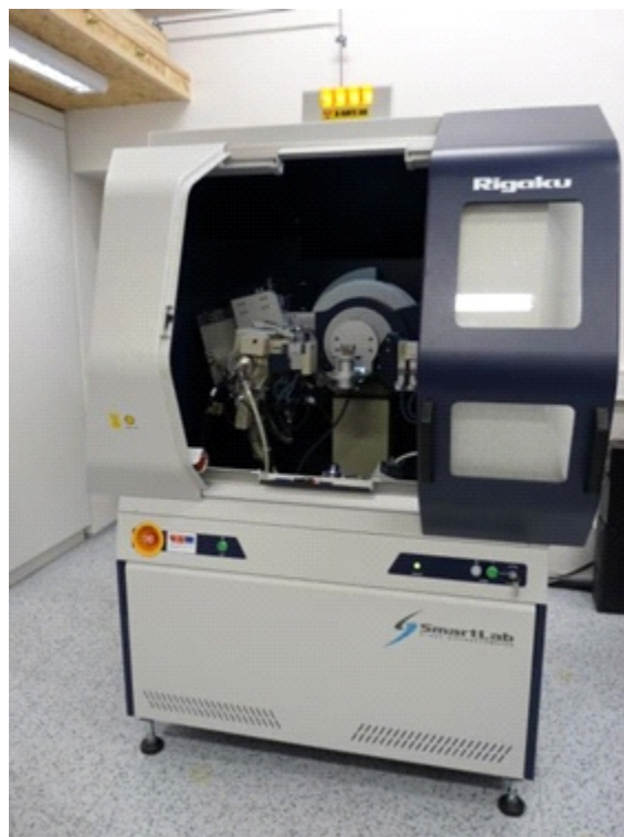
Obrázek 3: Difraktometr Rigaku SmartLab s rotační anodou. Na obrázku s rovinným držákem a kalibračním nástavcem a bez primárního monochromátoru.
