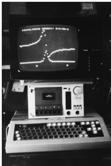
Obrázek 2. První počítačem řízený dvoukrystalový a trojkrystalový difraktometr s osmibitovým mikropočítačem IQ-151 v naší laboratoři. Vlevo je na televizní obrazovce vidět záznam difrakční křivky prošlého a difraktovaného svazku (z vlastního archívu poskytl J. Kuběna).
