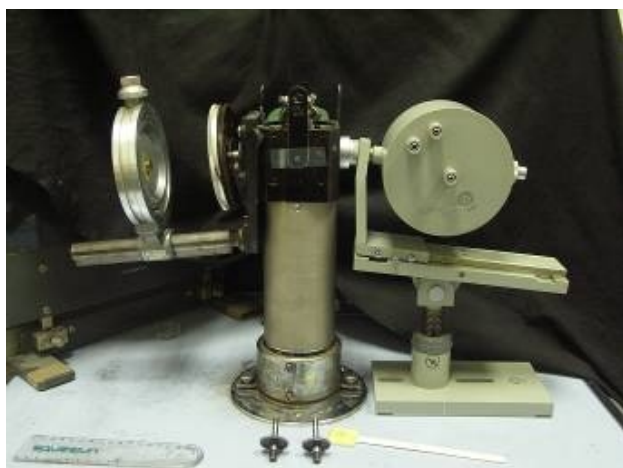
Obr. 8 RTG lampa s krytem na horní desce Mikromety 1 (foto: R. Kužel, MFF UK).
