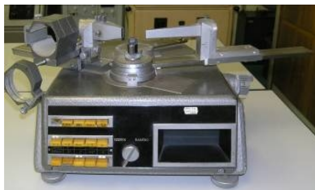
Obr. 10 Čelní pohled na RTG goniometr Chirana (foto: Fr. Filuš, VŠB Ostrava).
