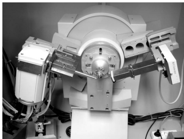
Obrázek 4. Debye-Scherrerovo uspořádání s 800 \mu m kapilárou na difraktografu X'Pert PRO, rok 2009.
