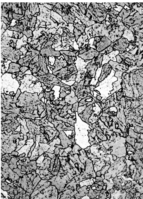
Obr. 2. Mikrostruktura oceli N při zvětšení 500x. Výbrus je rovnoběžný s osou trubky parovodu (a) resp. kolmý k ose parovodu (b).
