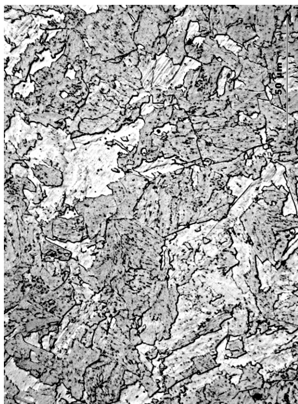
Obr. 2. Mikrostruktura oceli N při zvětšení 500x. Výbrus je rovnoběžný s osou trubky parovodu (a) resp. kolmý k ose parovodu (b).
