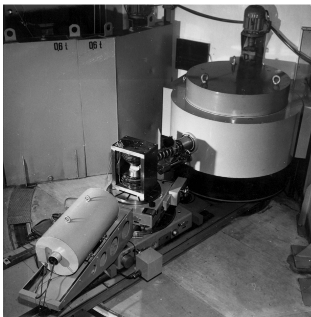
Obr. 1. První neutronový difraktometr SPN-100 vybudovaný vlastními silami pro experimenty s polarizovanými tak i nepolarizovanými termálními neutrony který je instalovaný u horizontálního kanálu HK-4.
