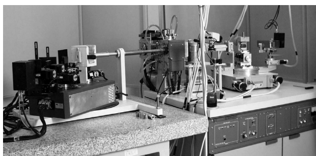
Obr. 1. Laboratoř Rotan je vybavena zdrojem s rotující anodou Rigaku, trojkrystalovým difraktometrem Bede a práškovým difraktometrem HUBER
