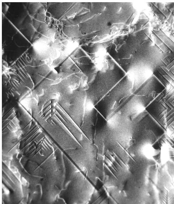
Obr. 2. Magnetické domény na topogramu vzorku Fe- 6 at.% Si, Langova metoda (Se svolením M. Polcarové)
