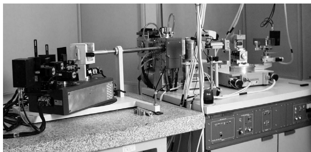
Obr. 1. Laboratoř Rotan je vybavena zdrojem s rotující anodou Rigaku, trojkrytalovým difraktometrem Bede a práškovým difraktometrem HUBER
